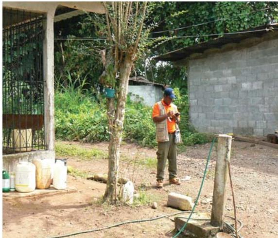
Cartógrafo actualizando en la provincia de Chiriquí en el 2009. Toma de puntos GPS con el receptor Trimble, para la preparación de los mapas.
